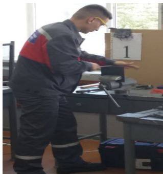
Рисунок 1 – Резка, опилование и доводка заготовок по разметке
