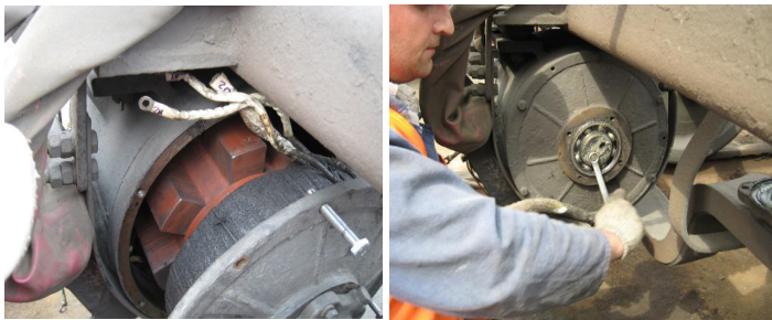
Рисунок 2 – Разборка и ТО-3 генератора индукторного типа в период производственной технологической практики на предприятии «Павлодарский участок Акмолинского филиала по ремонту пассажирских вагонов» студентом группы В-311 (2024 год).
