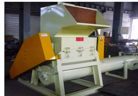
Рисунок 1 – Дробилка для переработки пластиковых ёмкостей
