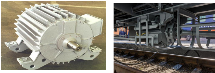
Рисунок 4 – Генератор ЭГВ.08.У1 R, РК привод от средней части оси колесной пары
