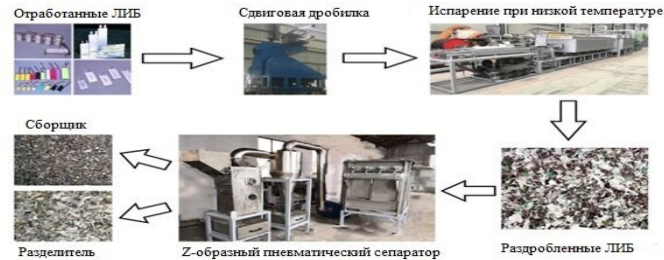
Рисунок 1 – Система переработки отработанных аккумуляторов
