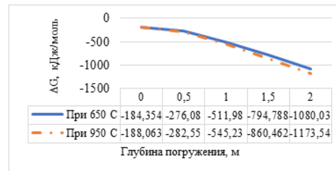
Рисунок 6 – График зависимости разницы изменений \Delta G для химической реакции AlB_2 + V = VB_2 + Al от глубины погружения навески флюса на основе бора в расплав алюминия при изменении температуры.
