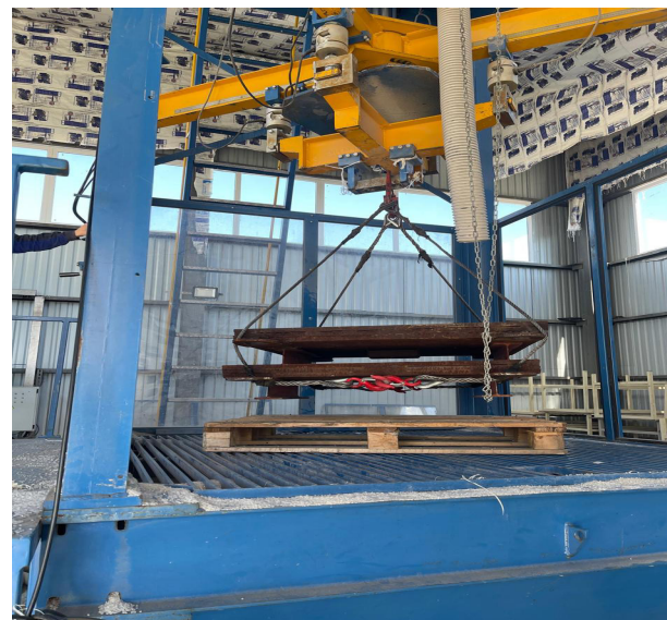
Рисунок 2 – Статический метод калибровки тензодатчиков с использованием системы подвеса
