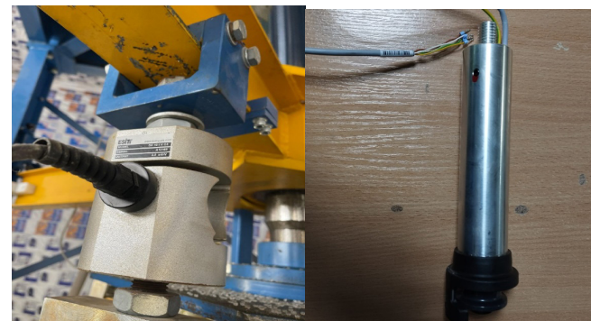
Рисунок 1 – Тензодатчики, используемые в Компании «Нефтехим LTD» для точного измерения нагрузки
